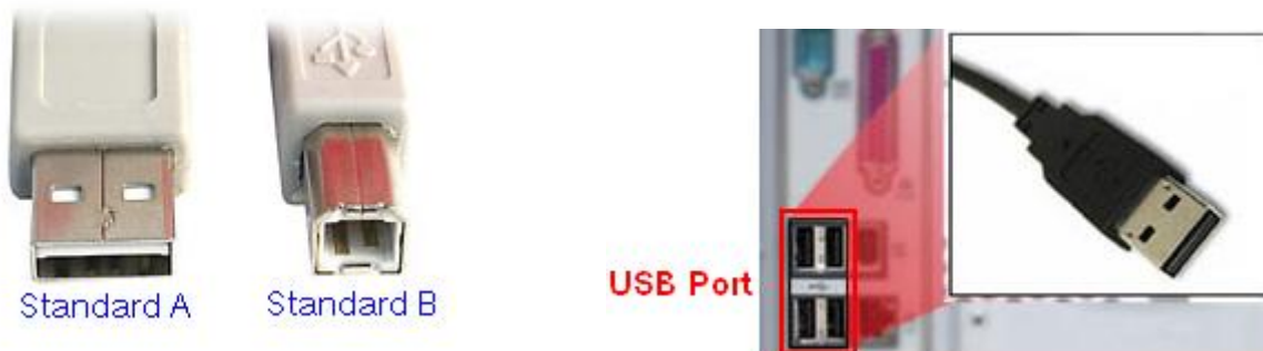
สาย USB และ USB Port ของเครื่องคอมพิวเตอร์
